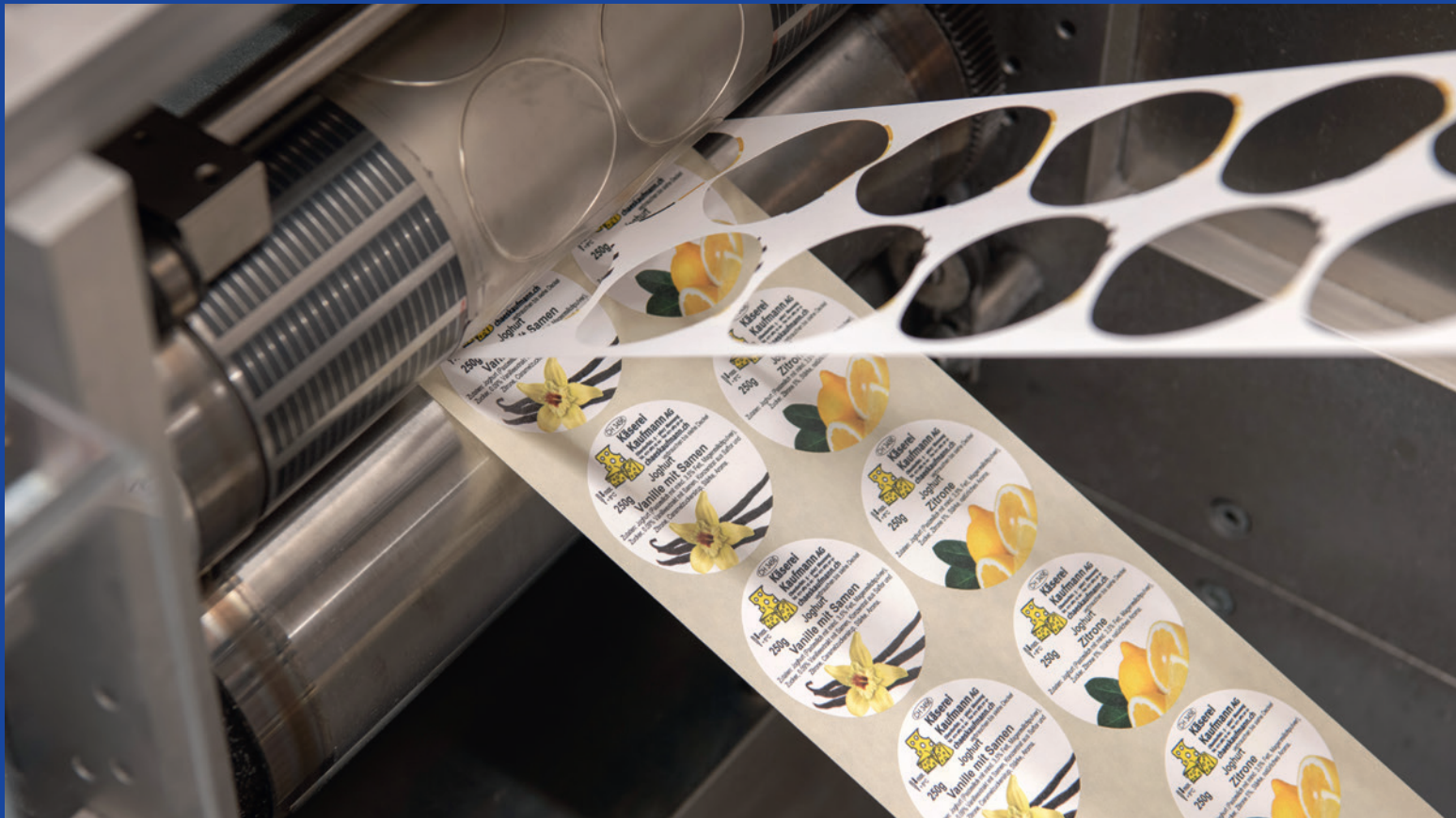
Neben Joghurtdeckeln aus Alu werden auch Etiketten gedruckt und ausgestanzt
